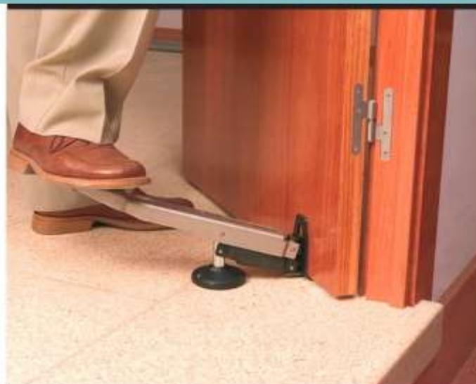
Con el EP70P se consigue una fácil y rápida extracción de las puertas, incluso en casos difíciles.
